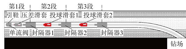
图 1 孔内分段压裂工具连接与工艺示意
